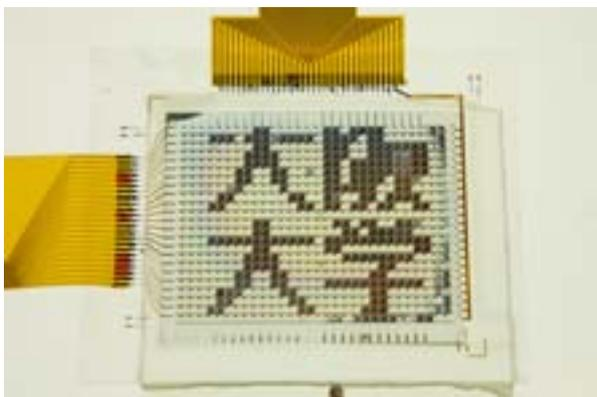
革新的な高性能有機トランジスタを用いた液晶ディスプレイパネルのデモ品
